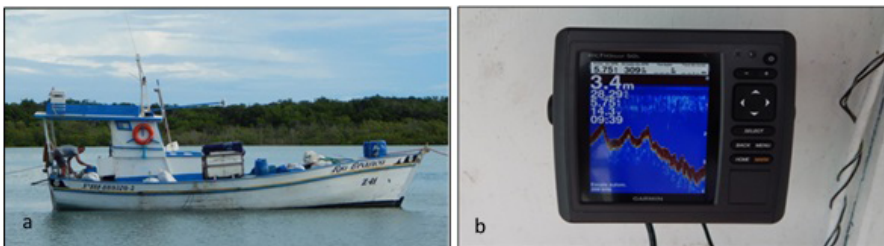
Figura 11.5 Embarcação da frota artesanal de rede de emalhar de fundo do Rio Grande do Norte (a); monitor da Ecosonda EchoMAP 50s GARMIN instalado na cabine de uma embarcação motorizada (b)
